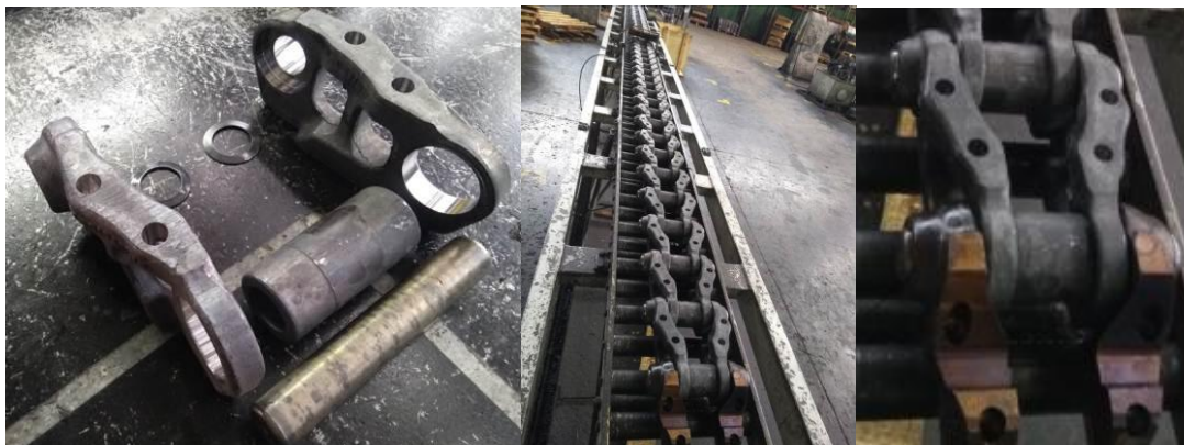
Figura 3,4 e 5 – Respectivamente: componentes das correntes de esteiras; corrente de rolamento sendo montada; detalhe da corrente de rolamento montada com as buchas.
